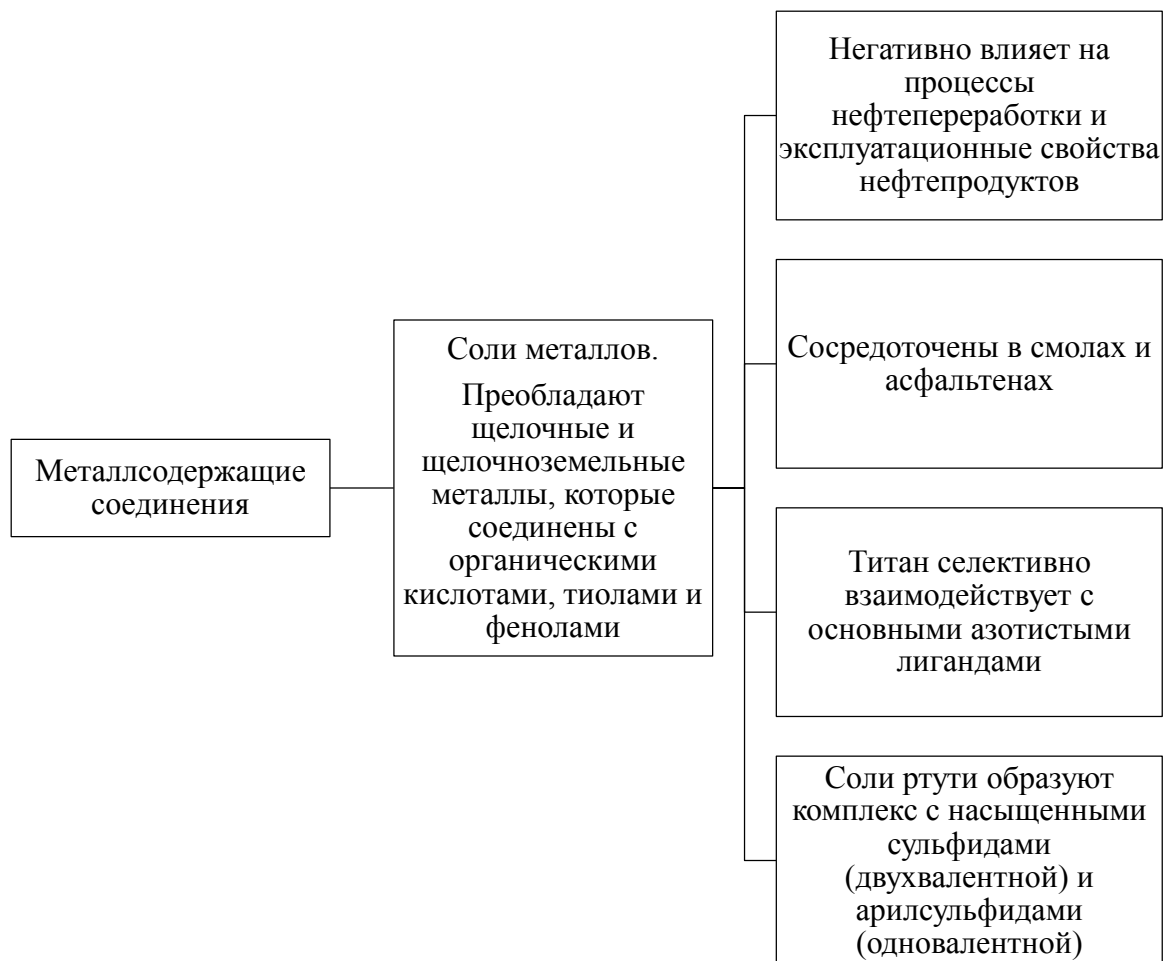
Рисунок 2 – Химическая природа металлосодержащих соединений сырой нефти [4]
